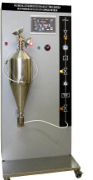
Автоматизированная установка определения характеристик износа катализатора для крекинга с псевдоожженным слоем воздушной струей экспресс методом
