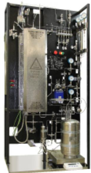
Автоматизированная лабораторная установка для тестирования катализаторов (КДИ) дегидрирования изобутана в кипящем слое
