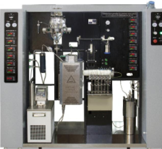
Автоматическая шестиканальная установка для испытаний катализаторов процесса крекинга в псевдоожженном слое (FCC)
