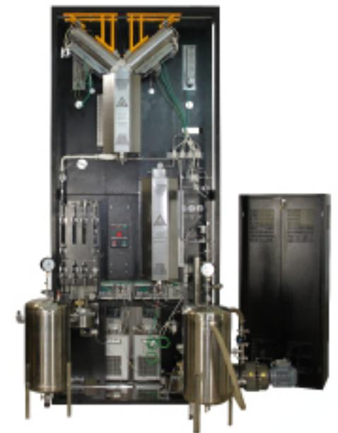
Пилотная установка для тестирования катализитической активности железонатриевых катализаторов дегидрирования
