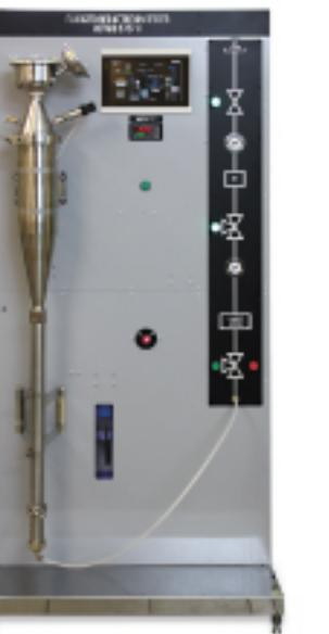
Автоматизированная установка определения износа катализатора для крекинга с псевдоожженным слоем воздушной струей согласно ASTM D5757-11
