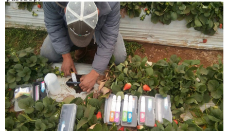
Фигура 6: Тестване на вода за напояване с компактни измервателни уреди LAQUAtwin.
