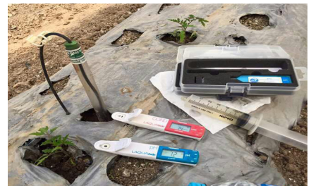
Фигура 5: Изпитване на рН и проводимост на почвен разтвор.
